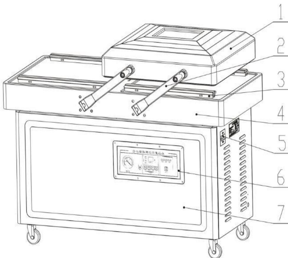
1. Крышка 2. параллельные рычаги 3. уплотнительная планка 4. вакуумная камера
